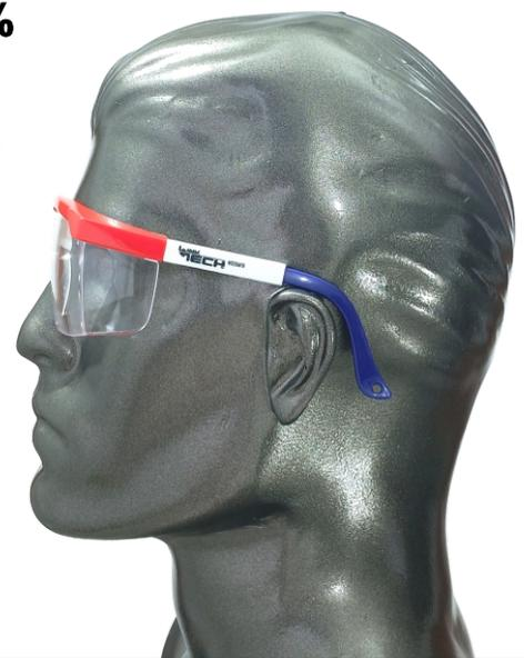
La norma Ansi Z87.1 de impacto básico especifica que un lente o antiparra fabricado bajo esta certificación debe ser capaz de resistir un golpe de un proyectil con punta con un peso de 500g, en caída libre vertical desde 1,27 metros de altura. (se pueden encontrar videos de demostración en Youtube buscando como "ANSI Z87.1 impac tes") Este nivel de protección esta pensado para resistir golpes de objetos de trabajo como martillos, objetos cortantes u objetos desprendidos en movimiento.
